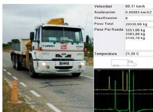
Figura 1. Balanza para pesado de vehículos en movimiento
